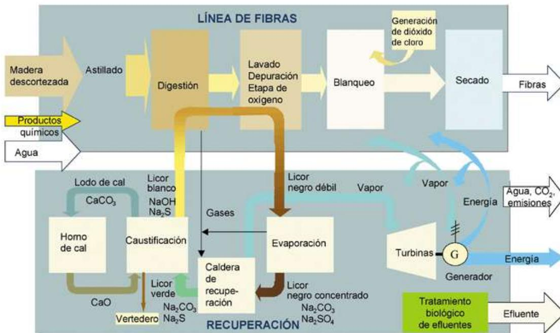
FIGURA 1/8. Diagrama del emplazamiento de la Fábrica
