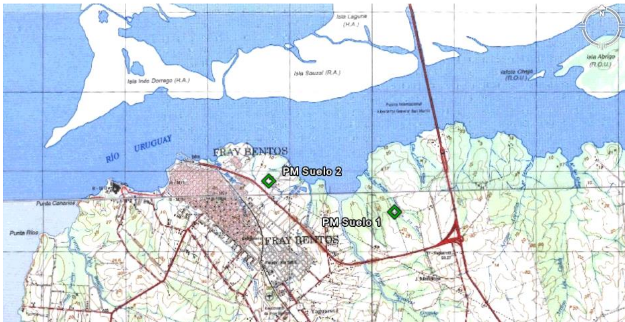
Figura 11. Localización de los puntos de muestreo propuestos para el monitoreo de la calidad del suelo: “PM Suelo 1” en el predio de la planta de UPM y “PM Suelo 2” junto a la estación de monitoreo de aire ambiente.
